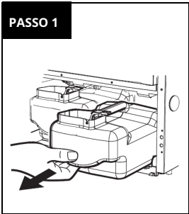
Deslize o depósito de água para fora.
